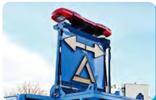
作業中に点灯する標識装置
