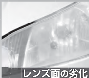
レンズ面の劣化
