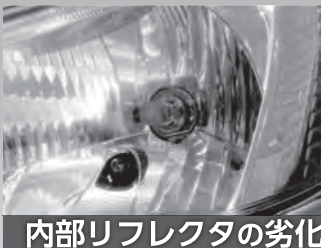
内部リフレクタの劣化
